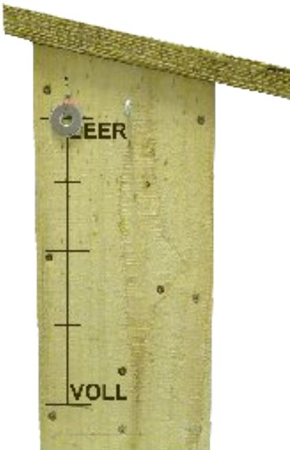
Bei leerem Futtersilo liegt das Metallgewicht unten auf dem Boden und die Unterlegscheibe wird ganz nach oben gezogen. Hier bringen Sie mit einem wasserfesten Filzstift die Markierung „LEER“ an.
